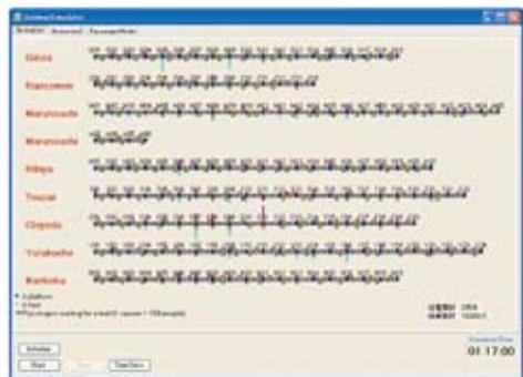
図1 バスの運行シミュレーション。緑色の玉がバスを表し、水色のバーがバス停で待っている乗客を表しています。
